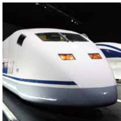
電車方式の速度世界記録 平成8年(443km/h)
